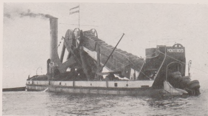
Abb. 19. Selbstfahrender Eimerkettenbagger (Abb. 7) mit Grundsaug- und Spüleinrichtung und einer Einrichtung zum Schutensaugen. Dampfantrieb. Tatsächliche Leistung 600 m 3 /h.
