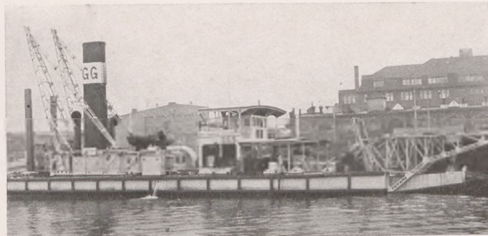
Abb. 15. Saugbagger (Cuttersauger) (Abb. 5) mit zwei Förderpumpen zum Herstellen und Vertiefen von Kanälen. Dampf-antrieb. Leistung 600 m 3 /h.
