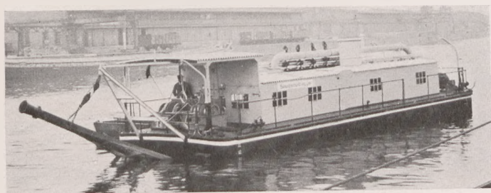
Abb. 14. Saug- und Spülbagger (Abb. 4) mit Dieselantrieb zum Vertiefen von Flüssen und Herstellen und Regeln von Bühnen. Leistung 50 bis 70 m 3 /h.
