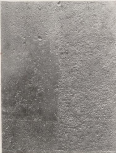
Abb. 15. Tafel nach Entfernung des Anstriches nach 4-jähriger Prüfzeit in Seewasser. Die linke Hälfte war 1 mal mit Chlorkautschukmennige gestrichen, der mittlere Teil außerdem 2 mal mit bitumenhaltigem Chlorkautschukdeckanstrich. Die rechte Hälfte war 1 mal, der mittlere Teil 2 mal mit einem Benzylcelluloseanstrich mit Oxydrot als Pigment gestrichen.
