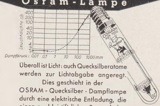
Überall ist Licht: auch Quecksilberatome werden zur Lichtabgabe angeregt. Dies geschieht in der OSRAM - Quecksilber - Dampfampe durch eine elektrische Entladung, die einen nur bleistiftgedicken Bogen hoher Leuchtdichte bildet. Dabei wird der elektrische Strom intensiv und vorteilhaft ausgenutzt — 2,5 mal so gut als in einer üblichen Glühlampe gleicher Wattzahl. Darum bieten auch
