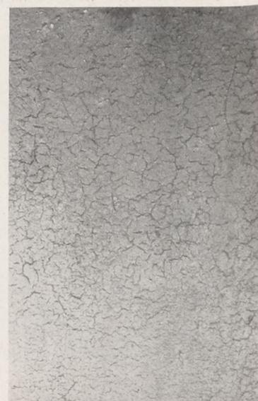
Abb. 14. 3-maliger Phenolharzanstrich mit Eisenoxydrot als Pigment. 1/2 Jahr in der Wasserwechselzone.
