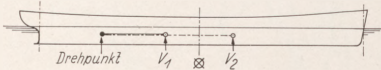
Abb. 11. Einfluß der Lage des Verdrängungsschwerpunktes auf das Stampfverhalten.
