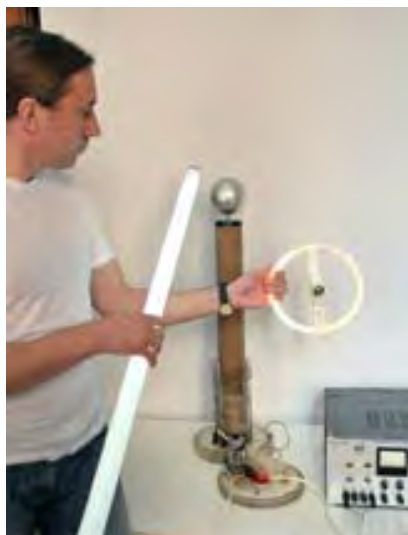
Rys. 5. Inżynier Jarosław Nowakowski demonstruje eksperymenty z wykorzystaniem nowoczesnej wersji transformatora Tesli, w którym w obwodzie pierwotnym wytwarzane są drgania za pomocą układu generacyjnego Meissnera
