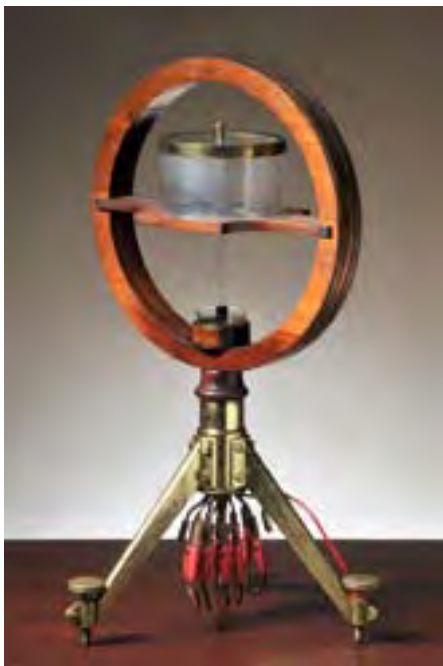
Rys. 6. Busola stycznych stosowana na I Laboratorium z fizyki do wyznaczania składowej poziomej natężenia pola Ziemskiego
