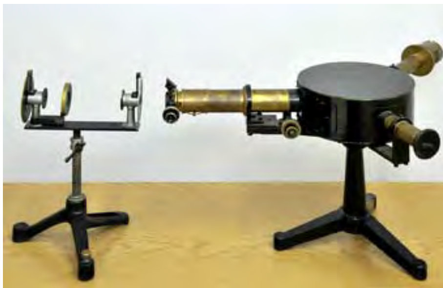
Rys. 9. Przyrząd służący do wyznaczenia zależności kąta skręcenia płaszczyzny polaryzacji w płytce kwarcowej od długości fali świetlnej. Składa się on z monochromatora, po prawej stronie, oraz umieszczonego na podstawie układu składającego się z polaryzatora, analizatora i płytki kwarcowej, po lewej stronie
