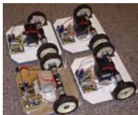
Fot. 2. Grupa 2-kołowych mechatronicznych platform mobilnych skonstruowanych w zespole nadzorowania procesów dynamicznych
