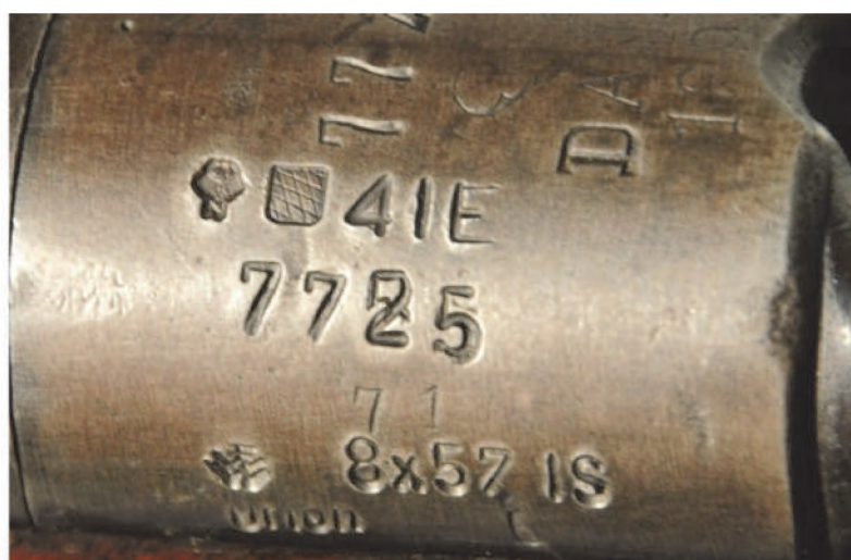
Przykład współczesnych niemieckich znaków akceptacji wybijanie na G88 produkcji GfD dopuszczające go obrotu handlowego.
