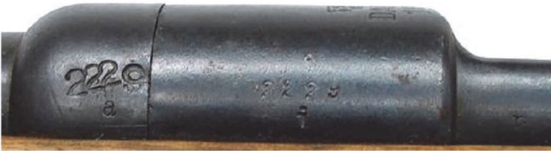
Przykład przebicia numeru seryjnego na osłonie lufy na numer seryjny 2229 zgodny z numerem na komorze zamkowej.
