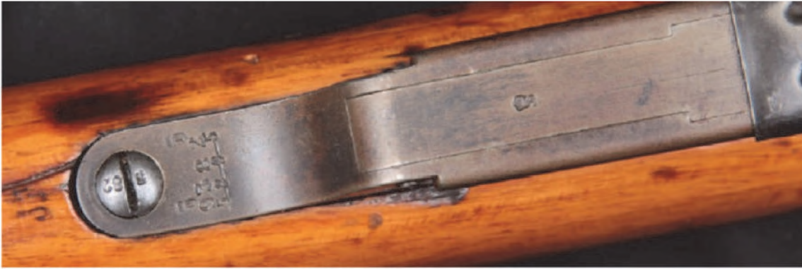
Przykład anulowania starego numeru seryjnego i nabicia nowego na osłonie magazynka, pochodzący z karabinu G88/05 produkcji GfD w roku 1890.
