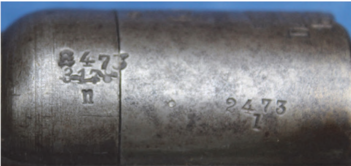
Przykład przebicia starego numeru seryjnego 3178 na osłonie lufy na numer seryjny 2473 zgodny z numerem na komorze zamkowej. Pochodzący z karabinu G88/05 produkcji GfD w roku 1892.
