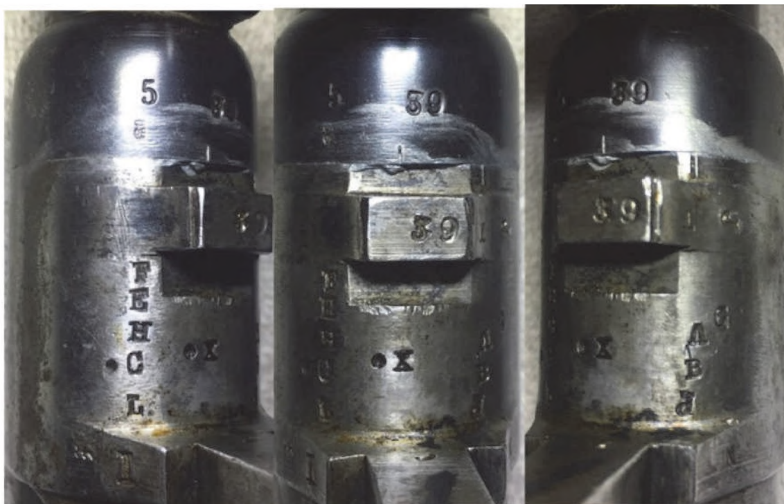
Przykładowe znakowania kontroli odbioru na komorze zamkowej i osłonie lufy umieszczone na jej spodzie w egzemplarzu G88 produkcji GfD z 1890 roku
