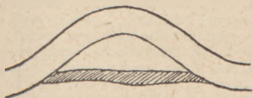
Ryc. 16. Zły sposób rozwiązania miejsca wygięcia drogi (odcinek zakreskowany — to wydeptana ścieżka kosztem zniszczenia strony wewnętrznej łuku drogi).
