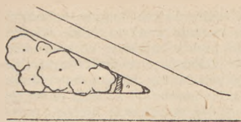
Ryc. 13. Zły sposób rozwiązania miejsca złączenia dwóch dróg (odcinki zakreskowane — to miejsca narażone na przedępanie).
