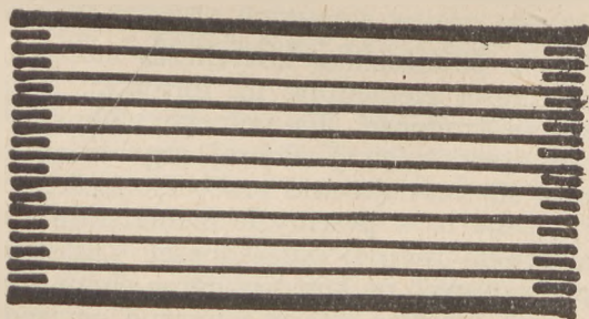
Rys. 1. Płyta pustakowa z odstępami na jedną listewkę.
