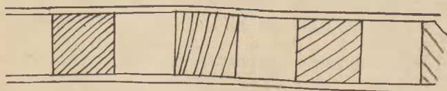
Rys. 5. Długie fale na przekroju płyty pustakowej, nie zniekształcają powierzchni.
