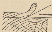
5. Ruch narzędzia w kierunku stycznym do przebiegu włókien
