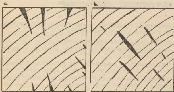
Rys. 5. Pęknięcia w drewnie: a — zewnętrzne, b — wewnętrzne.
