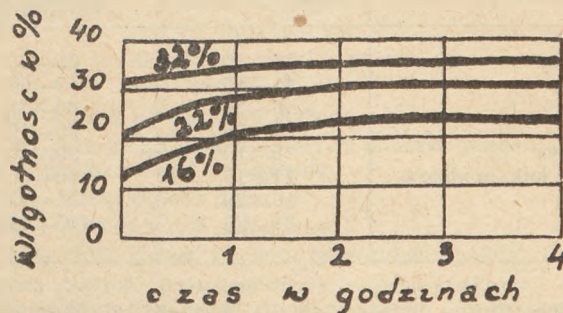
Rys. 1. Zmiana wilgotności drewna bukowego przy parowaniu. Wilgotność początkowa 16, 22 i 32% (według Mankiewicz).
