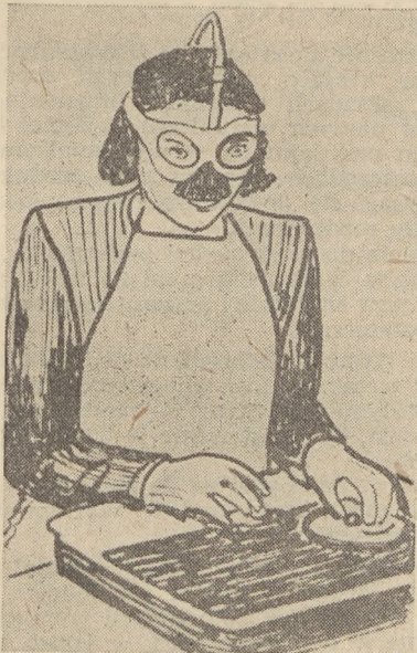
Rys. 5. Respirator-zasłona łącznie z ochronnymi okularami.
