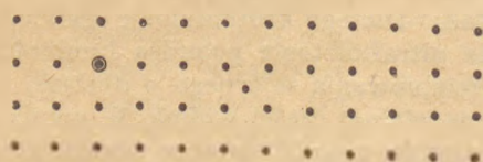
Rys. 3. Dwuwymiarowy obraz siatki krystalicznej przedstawiający możliwe przypadki zanieczyszczeń
