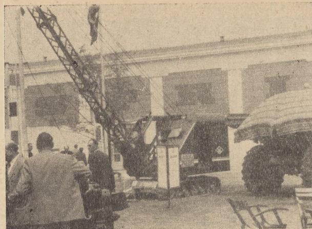
Rys. 3. Zachodnio-niemieckiej produkcji koparka linowo-zbierakowa typu „L-051”, o pojemności zbieraka 0,3 m 3
