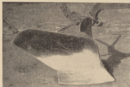
Rys. 3. Korpus pluźny pluga Condor
