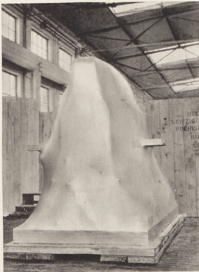
„kokonartig“ eingehüllte Fräsmaschine
