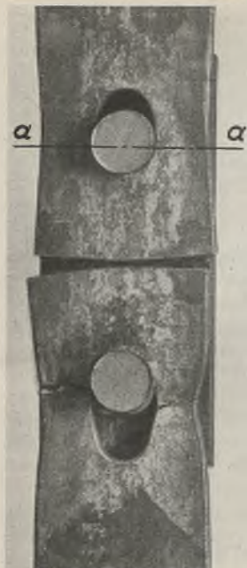
Abb. 4. Querschnitt a-a ist zu schwach.
