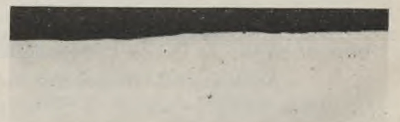
Abb. 3. Einwandfreie Walzhaut (Stahl b). (100fache Vergrößerung.)
