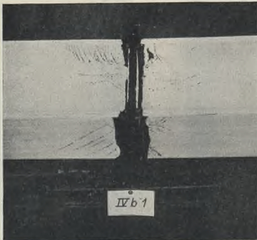
Abb. 43. Versuchsstab IV b 1 bei Laststufe 33,37 t (Bruchlast). Die Schweißverbindung ist zerstört. Fließfiguren in Steg und Flanschen des IP 20.
