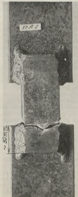
Abb. 12. Zerstrung durch wechselnde Belastung.
