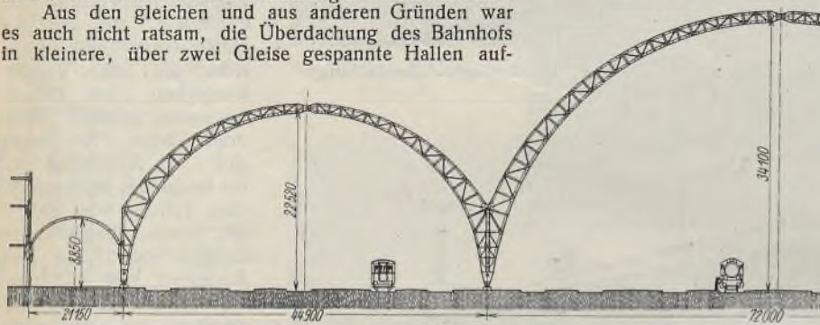
Abb. 1. Querschnitt der Bahnhofshalle Mailand.
