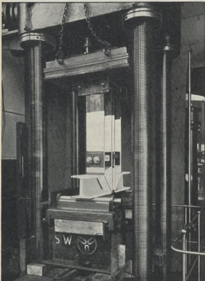
Abb. 11. Versuch IIa 2 , Steifrahmenecke. Versuchskörper in der Prüfmaschine.
