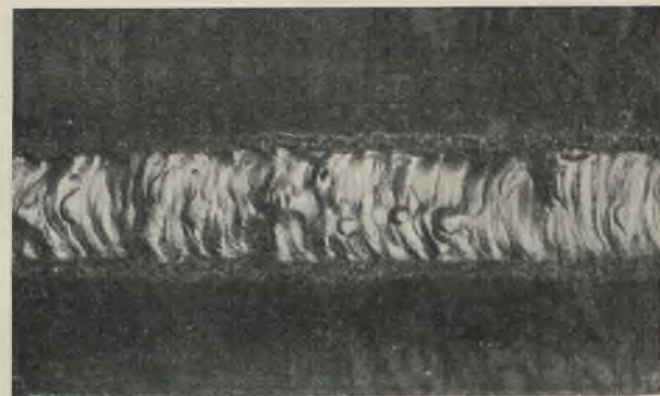
Abb. 5. Eine senkrecht gezogene Naht von etwa 100 mm Länge an einem Stabkreuz. Der Flu ist auch gut und dicht, aber etwas ungleichmäßig in der Höhe der Raupe. Man erkennt einige Poren.
