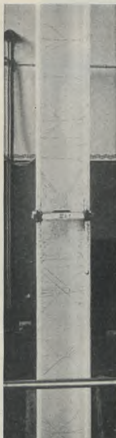
Abb. 39. Druck- (Knick-) Stab III b 1 bei Laststufe 178,46 t. Regelmäßige Fließfiguren von besonderer Form.
