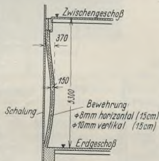
Abb. 11. Verformte Eisenbetonwand.
