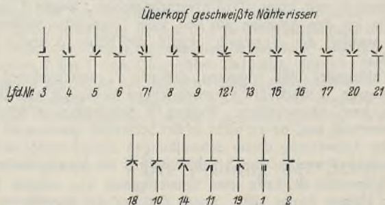
Abb. 2. Darstellung der Bruchformen in den Schweißungen.
