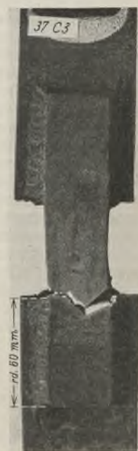
Abb. 13. Zerstrung durch statische Belastung.
