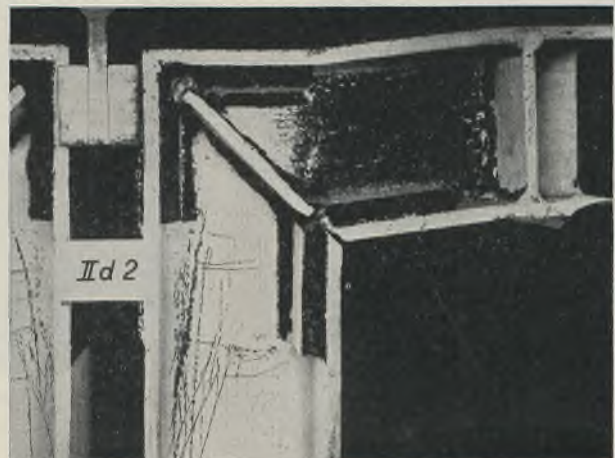
Abb. 29. Steifrahmenecke Id_2 . Laststufe 45,5 t (Bruchlast).
