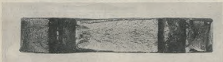
Abb. 10. Bruchfläche der Nietverbindung IIIc (Dauerversuch).
