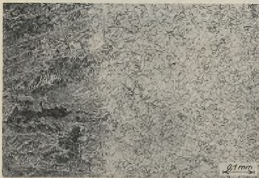
Abb. 21. Aus der Schweißung in Abb. 19; Übergang von der Schweißung zum C-Profil bei c .
