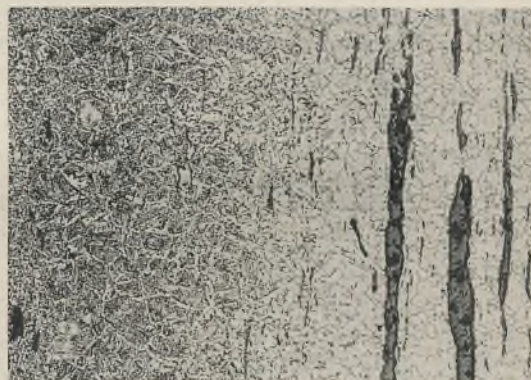
Abb. 10. Mikrogefüge aus einem Niet, geätzt. V = \times 100 .
