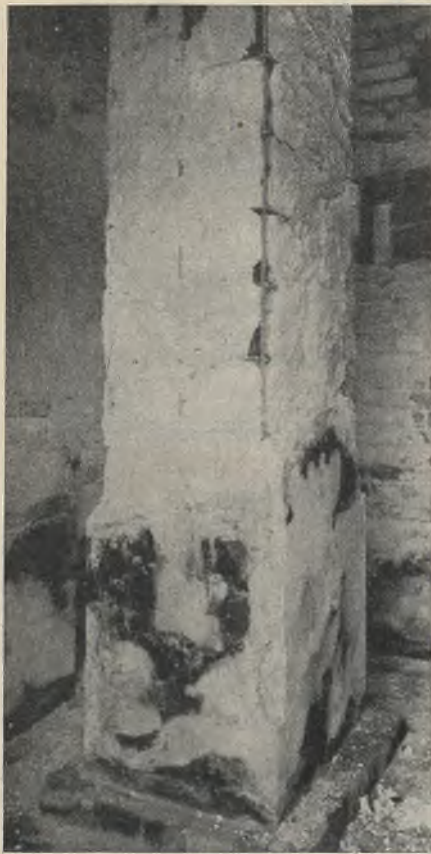
Abb. 4. Der äußere Mantel des Versuchsstückes Ausführung 1 in Gruppe A nach dem Ablöschen.
