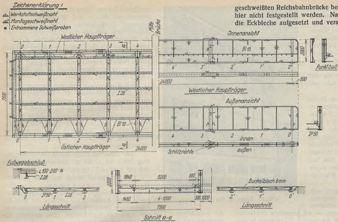
Abb. 6. Übersichtszeichnung mit Kennzeichnung der Werkstatt- und Baustellenschweißung.
