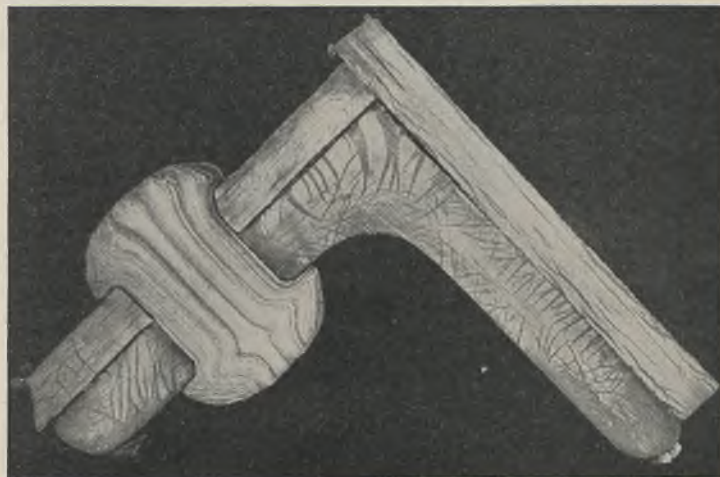
Abb. 8. Schnitt II (Abb. 1), 5 h bei 200° angelassen. Ätzung nach Fry.
