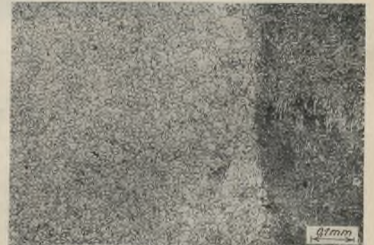
Abb. 24. Aus der Schweißung in Abb. 22; Übergang von der Schweißung zum C-Profil bei c .
