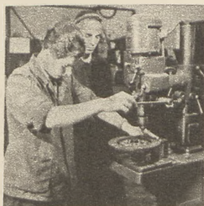
Uczniowie technikum przy pracy na wiertarce. Ryszard Ramiszewski i Janusz Skowronski wiertą otwory w łarży hamulcowej
