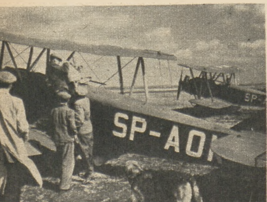
U góry: ładowanie nawozów sztucznych na samolot typu CSS-13 na lądowisku polowym. Poniżej: zmechanizowany system załadunku proszków owadobójczych na ciężki samolot Li-2, stosowany do opylania wielkich terenów leśnych. Pracownicy zatrudnieni przy ładowaniu proszków wyposażeni są w ochronne kombinezony, rękawice, buty oraz maski pyłochłonne. Znajdują się oni pod stałą i staranną opieką lekarską i posiadają na lądowisku apteczkę ze środkami przeciw zatruciu.
