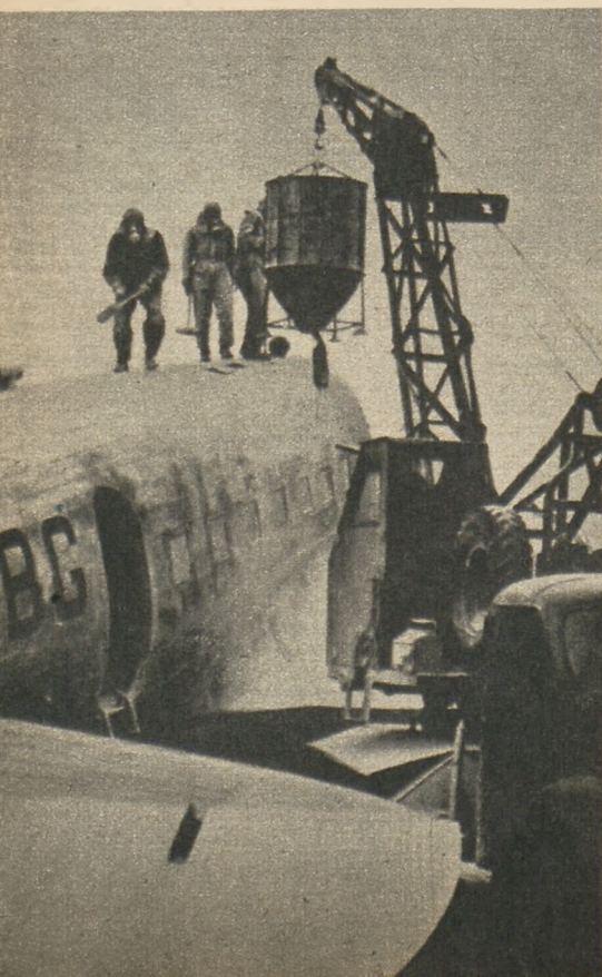
U góry: ładowanie nawozów sztucznych na samolot typu CSS-13 na lądowisku polowym. Poniżej: zmechanizowany system załadunku proszków owadobójczych na ciężki samolot Li-2, stosowany do opylania wielkich terenów leśnych. Pracownicy zatrudnieni przy ładowaniu proszków wyposażeni są w ochronne kombinezony, rękawice, buty oraz maski pyłochłonne. Znajdują się oni pod stałą i staranną opieką lekarską i posiadają na lądowisku apteczkę ze środkami przeciw zatruciu.
