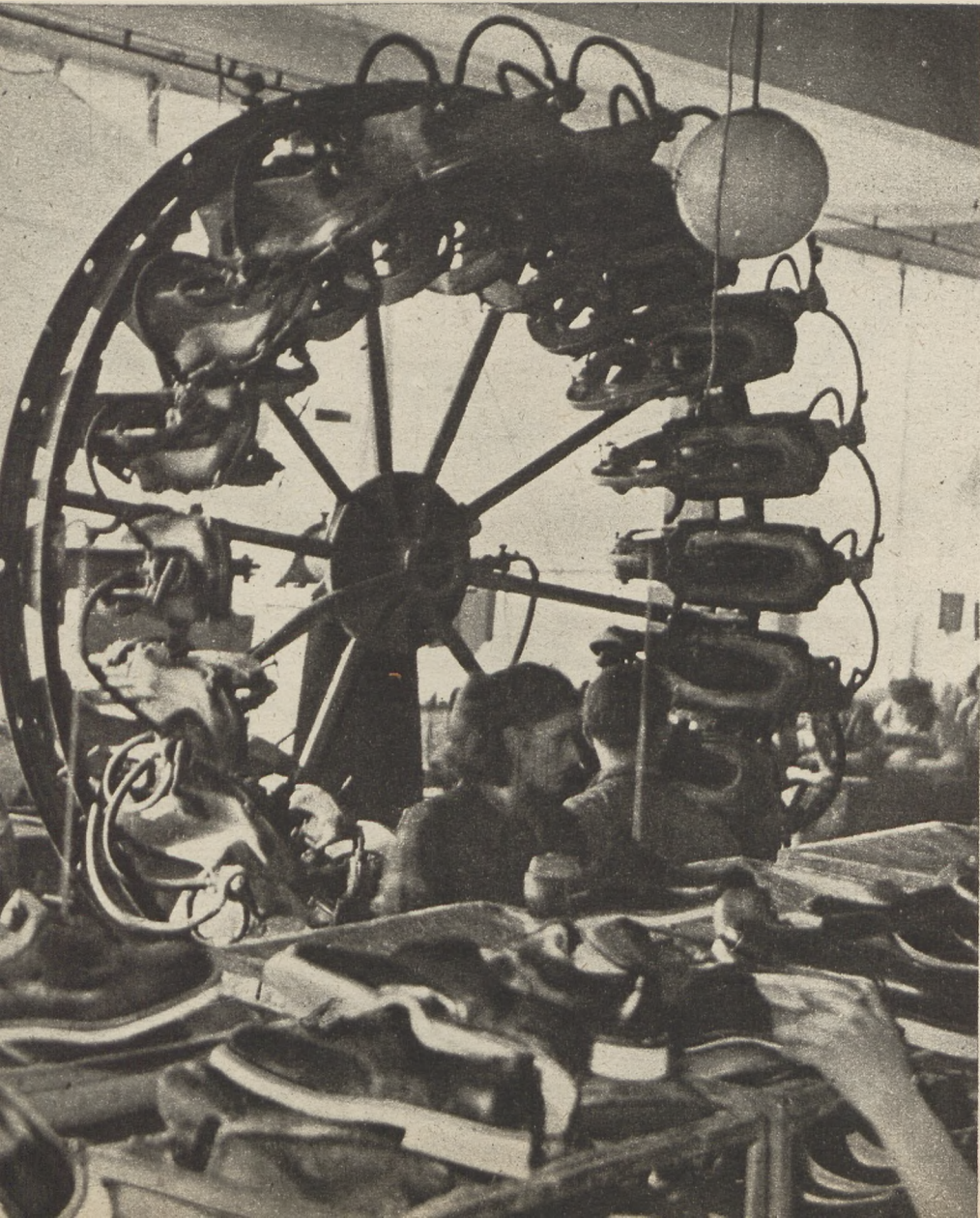
spajana jest podeszwa gumowa z wewnętrzną zelówką skórzaną. Laboratorium zakładów prowadzi nieustannie badania w celu ulepszenia dotychczas używanych klejów.
