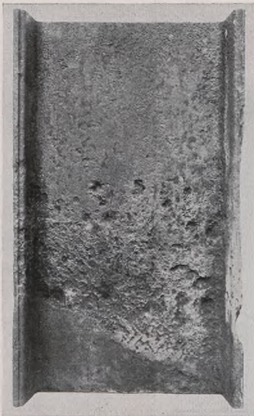
Bild 26. Unterer Abschnitt des I 20, entrostet. Seitenansicht.
