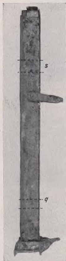
Bild 23. Monierwandträger mit Fuß (I 20). Alter 45 Jahre.
