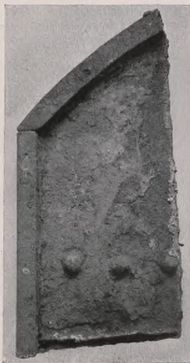
Bild 12. Teil des Flügelverschlusses. (Alter 75 Jahre.)
