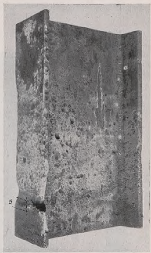
Bild 27. Unterer Abschnitt des I 20, entrostet. Schrägansicht.
