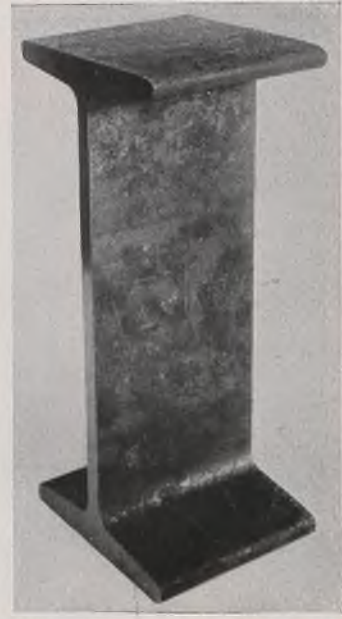
Bild 5. Schnitt a aus Bild 2 u. 3, entrostet (Bodenseite).
