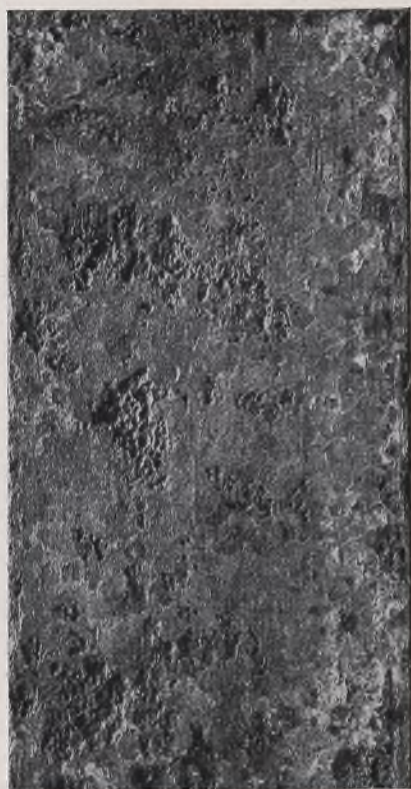
Bild 33. Abschnitt a aus Bild 32, entrostet.
