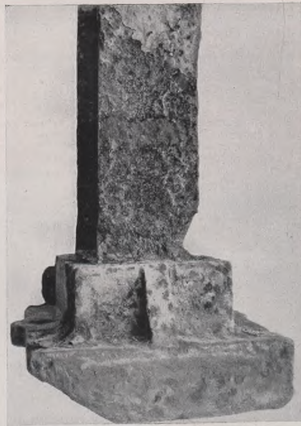
Bild 25. Wasserseite des unteren Abschnittes des I 20 mit Fuß. (Alter 45 Jahre.)
