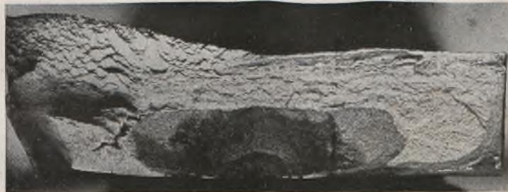
Bild 1. Ausbreitung des Risses unter der Oberfläche.
