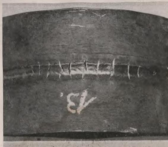
Bild 22. Aufschweißbiegeprobe mit zahlreichen Anrissen.
