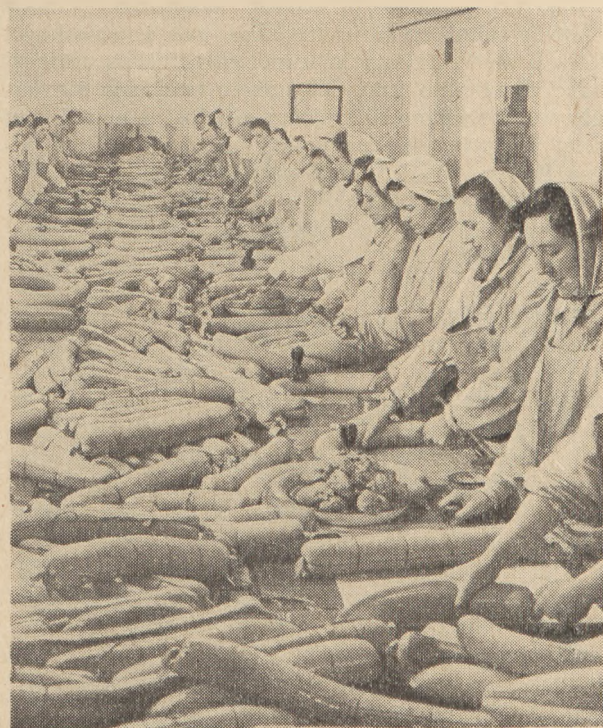
Rys. 4. Sznurowanie batonów salami. 1 — końcowa faza sznurowania (pierwsza pracownica z prawej strony), 2 — początkowe upychanie masy mięsnej w osłonce (druga pracownica z prawej strony), 3) — podłużne sznurowanie batonu jako faza wstępna w celu jego wyprostowania (trzecia pracownica z prawej strony); uwagę zwraca dziurkacz służący do perforacji osłonki i przytrzymywania szpagatu, oraz napełniarka leżąca, umieszczona w oddzielnym pomieszczeniu, widoczna na tylnym planie
