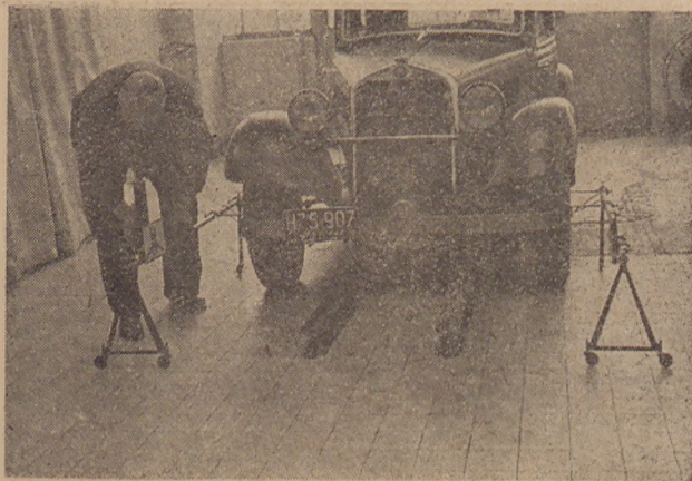
Rys. 3. Ustawienie przyrządu optycznego przy przeprowadzaniu pomiaru zbieżności kół
