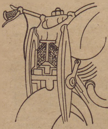
Rys. 3. Przednie zawieszenie motocykla na wkładkach gumowych poddawanych ścisnaniu (konstrukcja nowsza)
