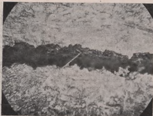
Bild 11. Zerfranste Ränder eines Blechrisses infolge Dauerbeanspruchung.
