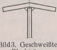
Bild 3. Geschweißter Blechträger. Durch Schrumpfung gebogene Lamelle, die nur an den Kanten aufliegt. Die Druckübertragung erfolgt nur durch die Schweißnähte.
