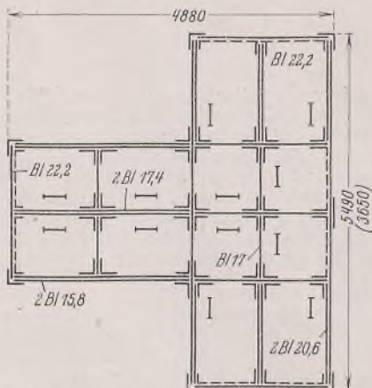
Bild 5. Querschnitt des Pylonenstiels.
