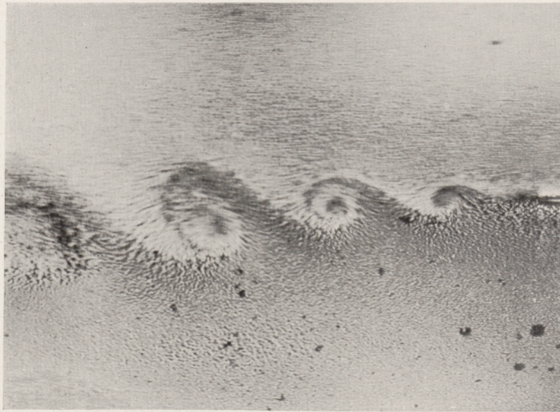
Abb. 19. Strombildaufnahme über die Wirbelbildung in Flüssigkeiten
