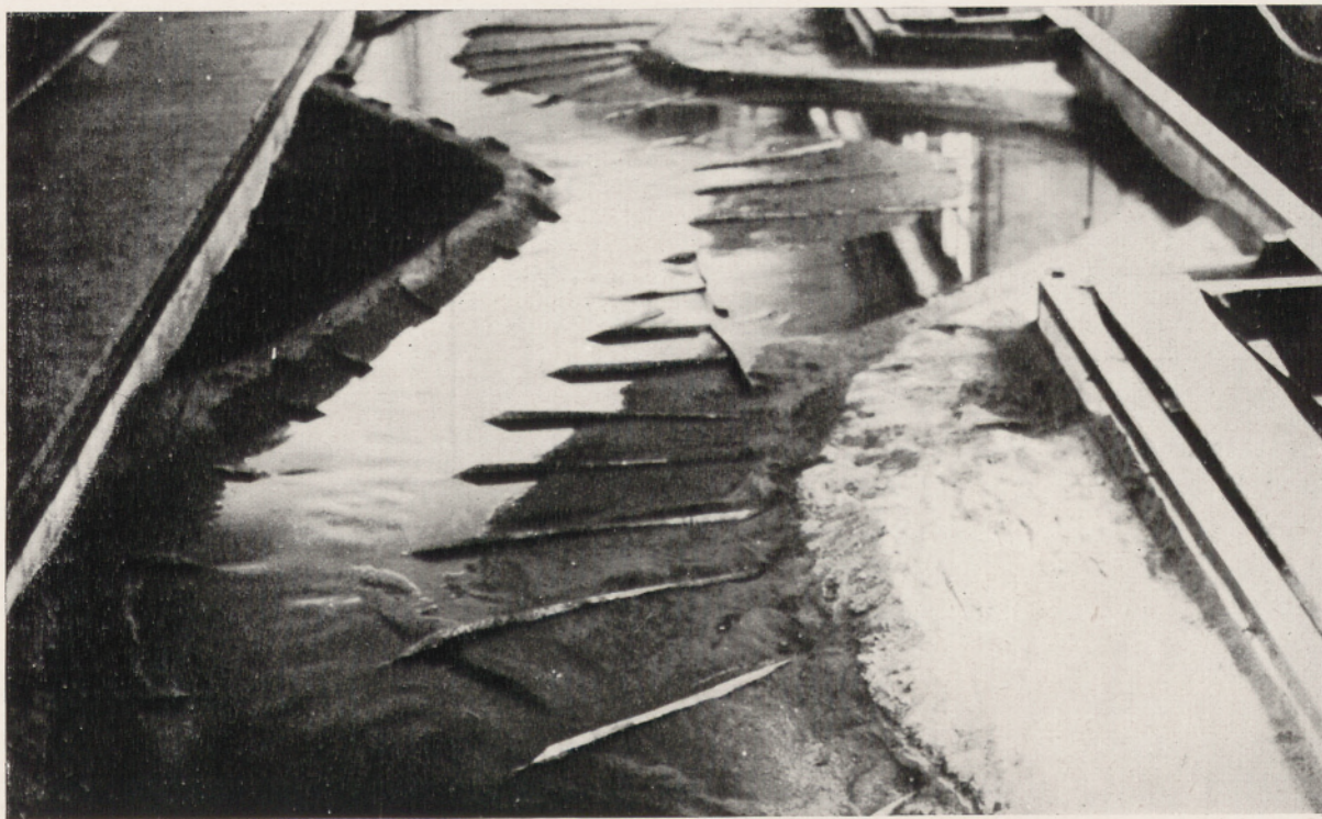
Abb. 24. Verwildertes Flußbett, durch Buhneneinbau geregelt
