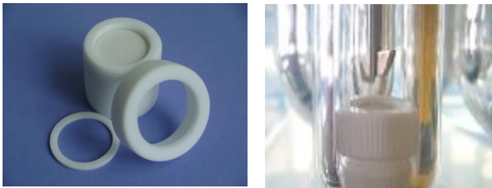
Ryc. 10. Komora ekstrakcyjna stosowana w badaniu uwalniania (typu VanKel).
