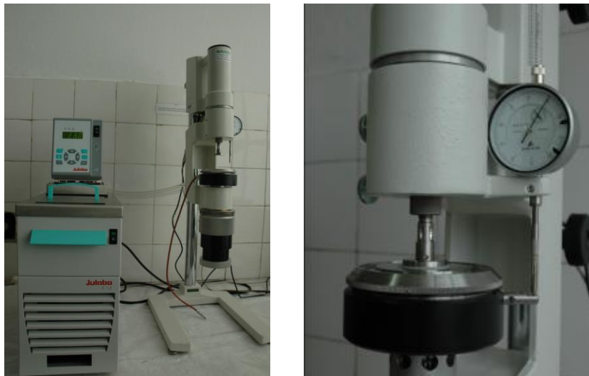
Ryc. 14. Reometr typu VT 550 – układ pomiarowy płytka-stożek.
