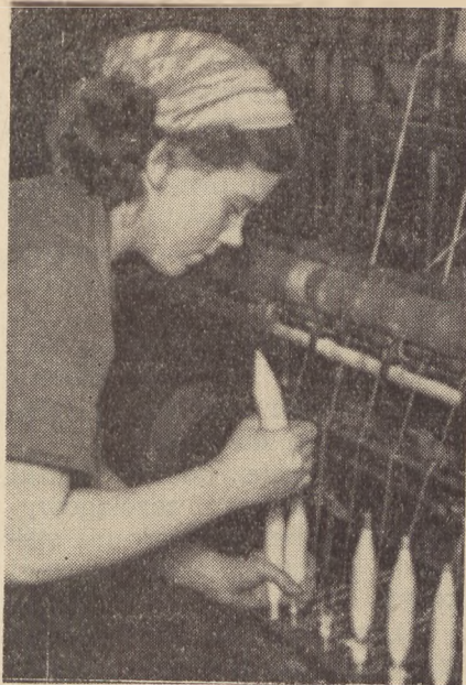
5. Lewą ręką chwyta kopkę z drugiego wrzeciona pomiędzy końcową część kciuka, a pozostałe cztery palce.
