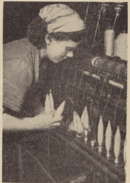
9. Lewą ręką chwyta kopkę z wrzeciona 6, pomiędzy pale wskazującym, a pozostałymi trzema.
