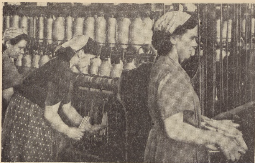
22. Odnoszenie skrzyneczki z przędzą oraz zakończenie natykania cewek przez drugą obciążaczkę.
