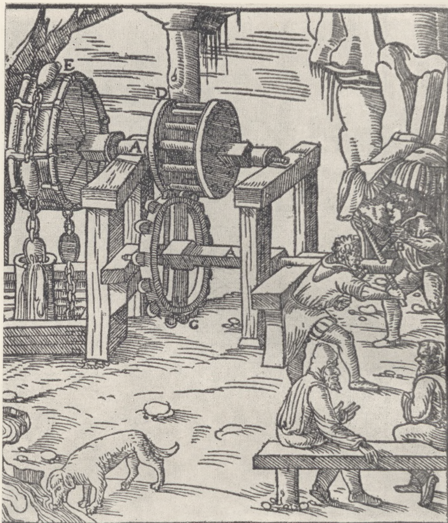
Il. 25. Pompa odwadniająca, drzeworyt z dzieła Agricoli.
