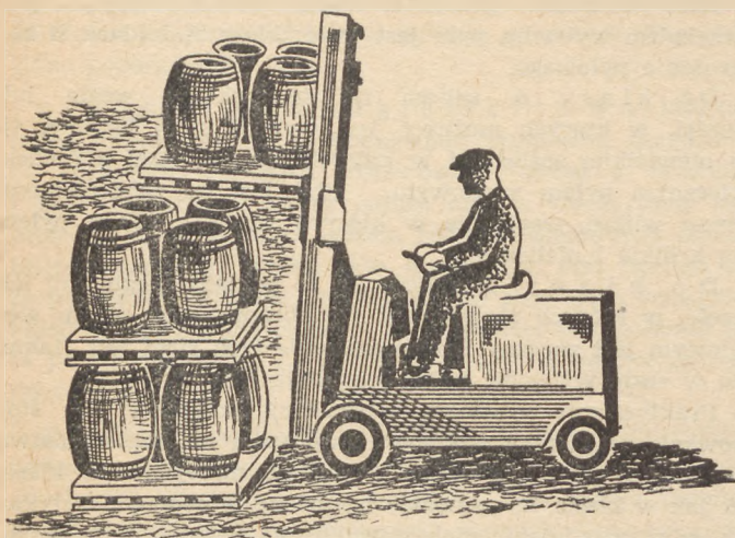
2 — Układanie (3 warstwy) beczek w magazynie przy pomocy wózka podnośnego i tac ładunkowych
