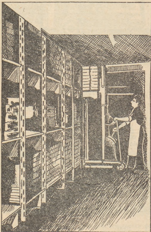
9 — Mały wózek podnośny układający tace z towarem na półkach magazynu
