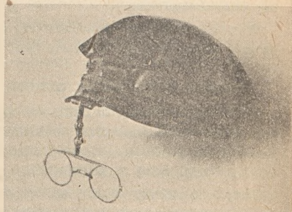
Rys. 10. Okulary otwarte z uchwytem do zamocowania w pozycji „ochronnej”. Ciężar okularów wraz z uchwytem około 100 g; średnica szybki 45 do 50 mm. Szybyki ze szkła klejonego lub nieorganicznego
