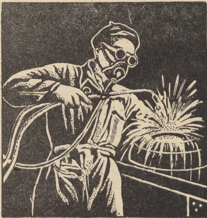
Rys. 3. Zastosowanie aparatów oddechowych izoluje całkowicie spawacza od otaczającej atmosfery.
