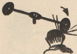
Rys. 3. O ile głowa pracownika znajdzie się na torze kul, w którymkolwiek miejscu, zostanie nimi uderzona.
