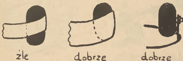
Rys. 8. Kule nie mogą wystawać poniżej dolnej krawędzi obręczy.
