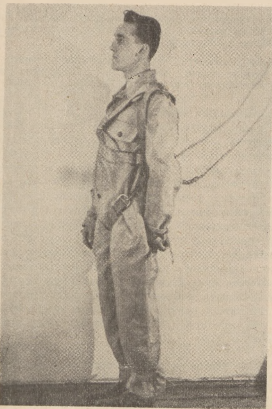
Rys. 3. Szelki włókiennicze obejmujące ramiona i pachwiny (z linką stalową do podwieszenia)
