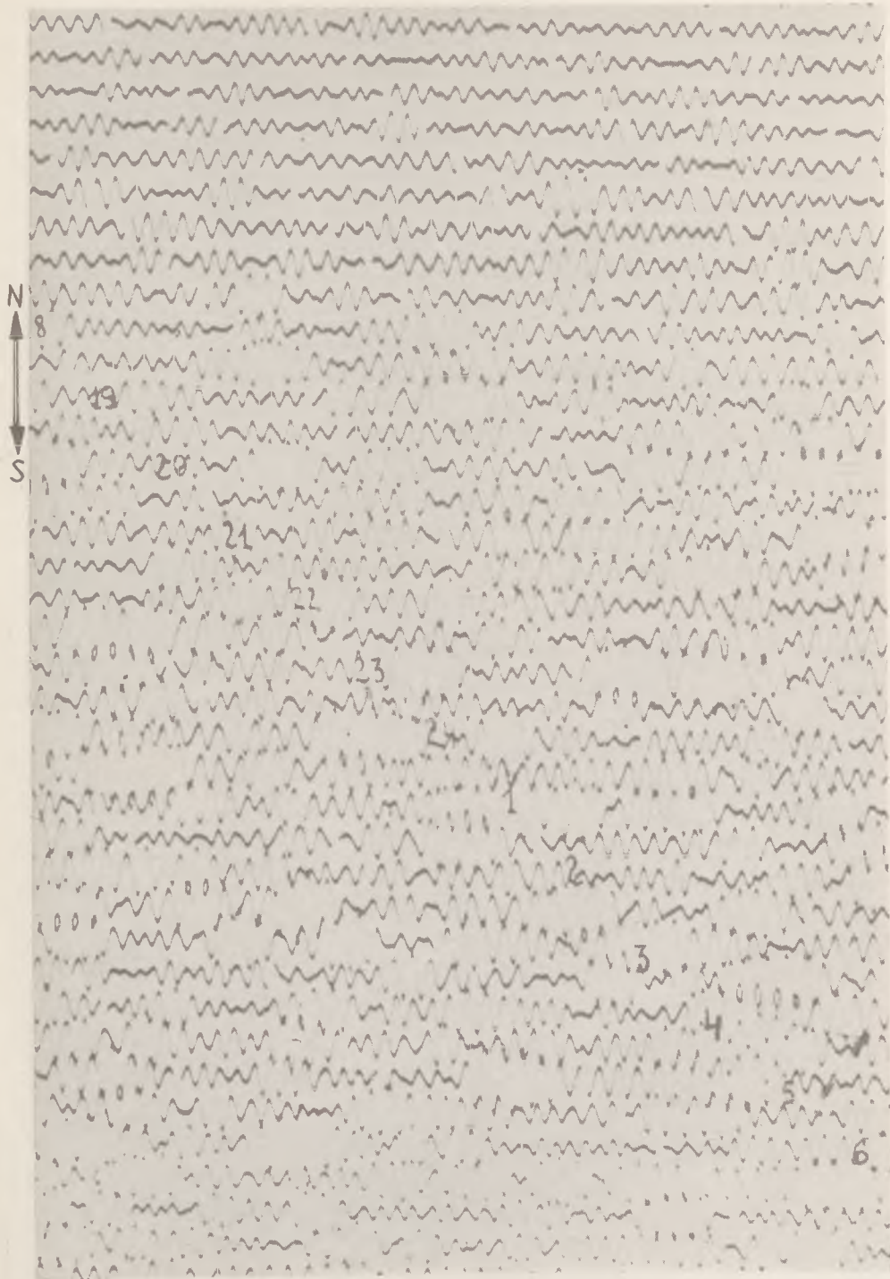
Rys. 9. Ruchy mikrosejsmiczne Ziemi zapisane w dniach 18-19 marca 1959 roku przez sejsmografy Obserwatorium Sejsmologicznego w Warszawie (minuty wzrastają od prawej do lewej). Poprawki zegara: 18.III.1959 - 13,0 s . 19.III. 1959-13,0 s . Składowa N-S
