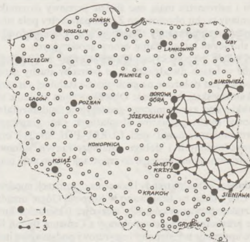
Rys. 7: 1 – punkt pomiarów absolutnych, 2 – punkt pomiarów względnych, 3 – pomiary względne wykonane w 1994 r.
