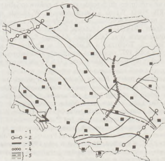
Rys. 1: 1 – punkt sieci geodynamicznej, 2 – profil GPS, 3 – linia niwelacyjna pomierzona w 1994 r., 4 – linia niwelacyjna do pomiaru w 1995 r., 5 – główne i podrzędne granice geologiczne
