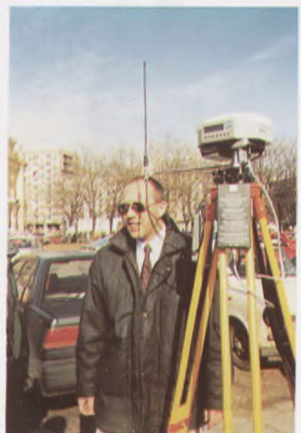
Pomiar satelitarny w terenie odbiornikiem RM24. Działanie odbiornika objaśnia Dirk Westenberger
