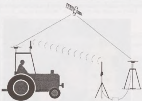
Rys. 1. Schemat działania metody różnicowej DGPS
