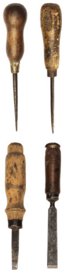
▲ Narzędzia do prac rymarskich wykonane przez dziadka autora podczas pracy przymusowej na terenie Niemiec podczas II Wojny Światowej. Używając ich autor za każdym razem docenia mądrość płynącą z doświadczenia ich twórcy. Profile uchwytów (rękojeści) wynikają z wiedzy o ich przeznaczeniu i sposobie postępowania się nimi.
