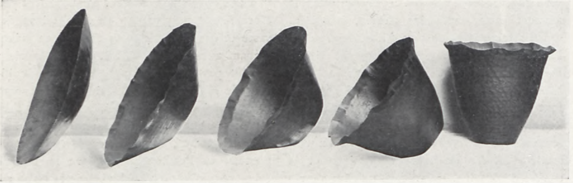
Etats successifs d'un vase en cuivre monté au marteau.
