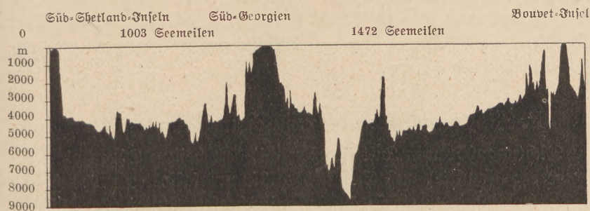
Abb. 90. Meeresbodenprofil nach der Forschungsfahrt, ermittelt durch 2485 Echolotungen mit dem Atlas-Echolot. In 185 facher Überhöhung dargestellt.
