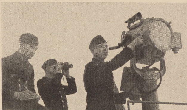
Abb. 119. Eine Signalstelle der Kriegsmarine gibt mit Signal-scheinwerfer eine Meldung weiter. Mit dem Prismenglas werden die Zeichen der Gegenseite beobachtet.
