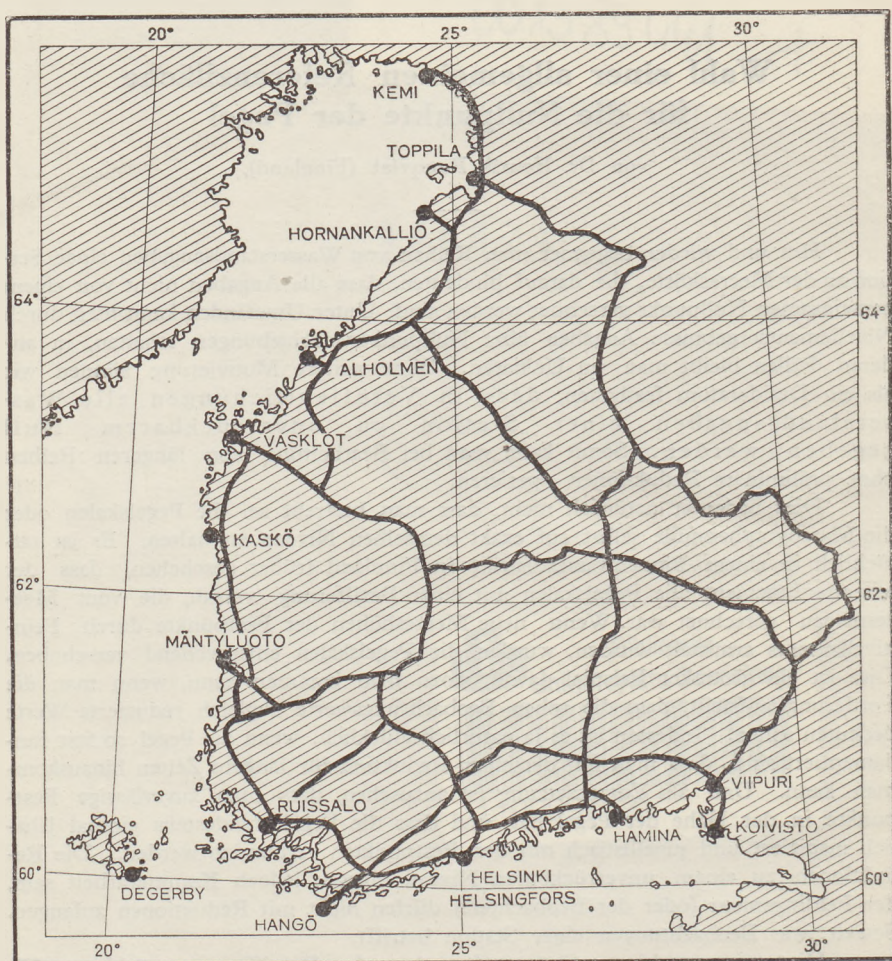
Fig. 1. Die Mareographenstationen an den Küsten Finnlands, das Hauptnetz des Präzisionsnivellements und die Anschlusslinien zu den Mareographenstationen.
