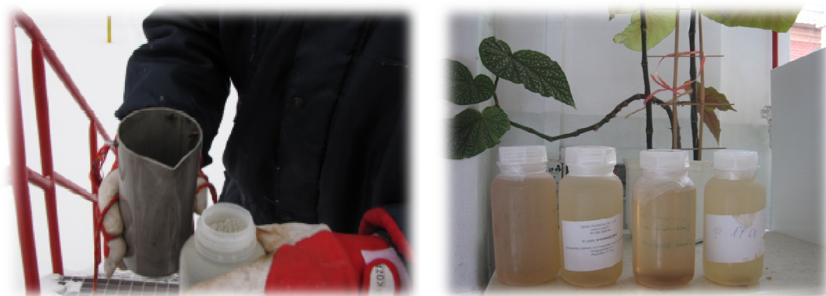
Rysunek 17. Fotograficzna dokumentacja etapu przepłukiwania medium wodnym pojemników z tworzywa sztucznego (rys. lewy) oraz pobrane próbki ścieków „pod korek” (rys. prawy).
