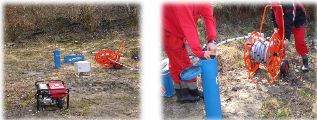
Rysunek 18. Wygląd sprzętu (rys. lewy) używanego do pobierania próbek wód podziemnych (rys. prawy).
