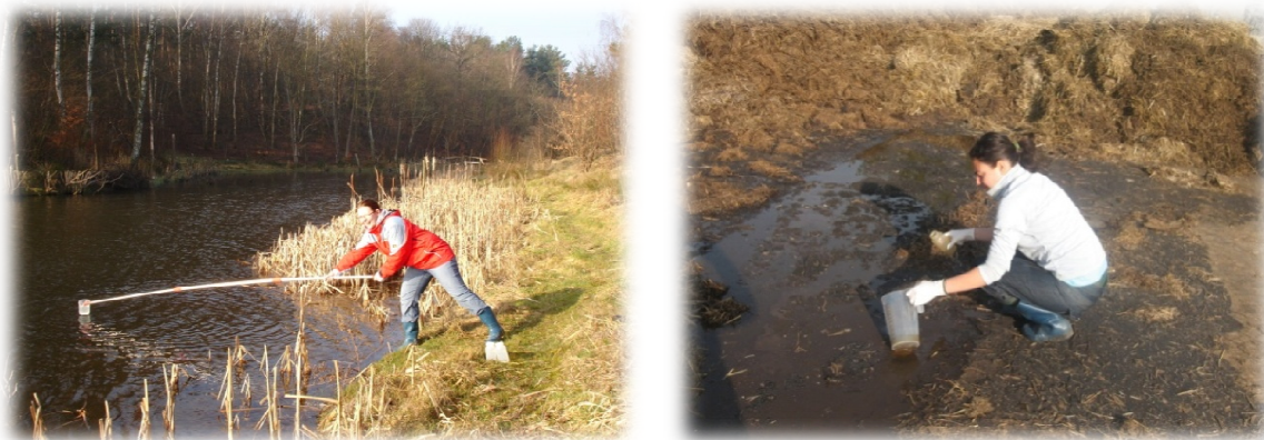
Rysunek 20. Dokumentacja fotograficzna etapu pobierania próbek wód powierzchniowych z okolic składowiska odpadów komunalnych (rys. lewy) oraz próbek ścieków pochodzących z hodowli bydła (rys. prawy).
