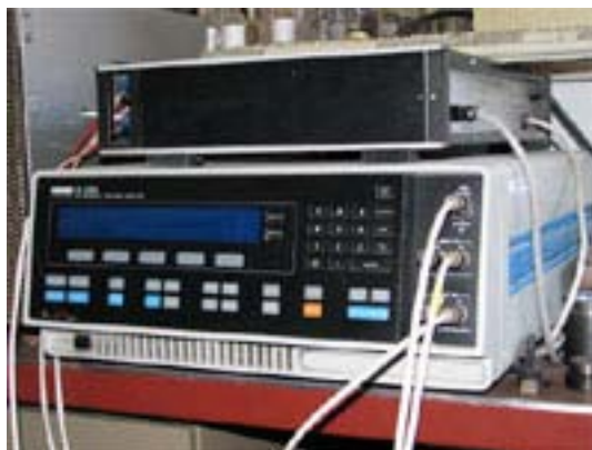
Rys. 62. Analizator Transmitancji Schlumberger SI 1255 z wysokoimpedancyjną przystawką ATLAS 9181.
