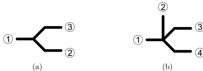
RYSUNEK 5.2: Schemat ogólny: (a) rozgałęzienia T , (b) rozgałęzienia magicznego- T .
