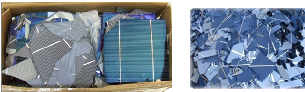
Rys. 5. 97. Nadmiernie rozdrobniony odpad pochodzący z uszkodzonych ogniw PV (materiał badawczy zebrany do prób)
