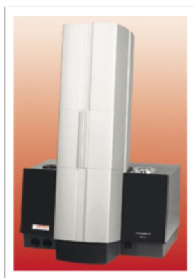
Rys. 5. 103. Laser Particle Sizer ANALYSETTE 22 a- sposób pomiaru małych cząstek, b- sposób pomiaru dla dużych cząstek [94]
