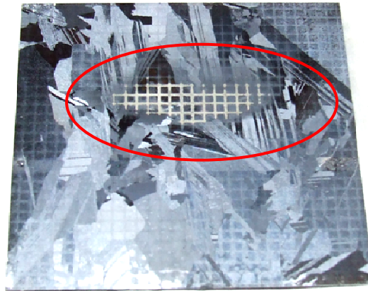
Rys. 5.62. Efekt niewłaściwego umieszczenia ogniw PV w roztworze trawiącym [65]
