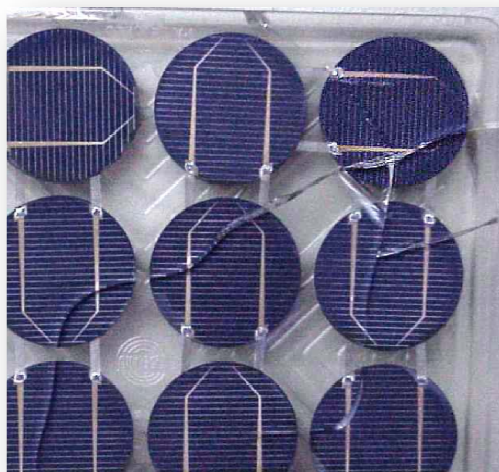
Rys. 3. 24. Uszkodzenie pokrycia przedniego modułu PV – pęknięcia szkła [26]
