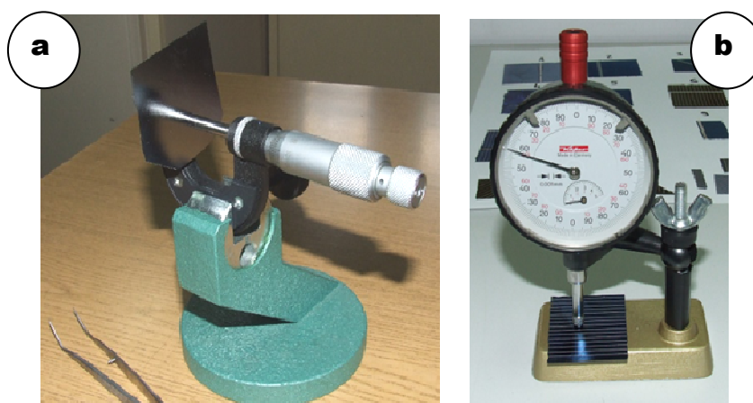
Rys. 5. 65. Pomiar grubości ogniw PV z wykorzystaniem: a – śruby mikrometrycznej, b – czujnika zegarowego [66]
