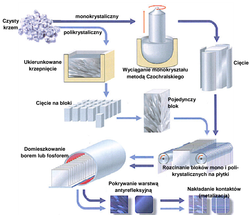
Rys. 3. 3. Wytwarzanie mono i polikrystalicznych krzemowych ogniw fotowoltaicznych (opracowano w oparciu o [80])
