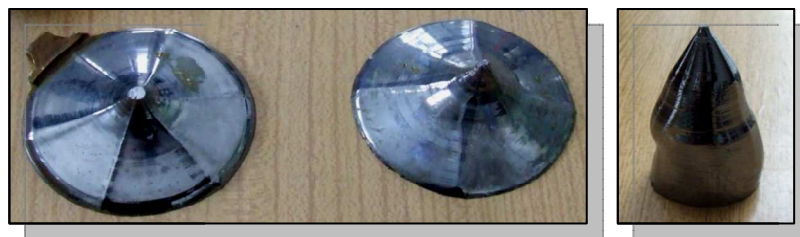
Rys. 3. 5. Odpad krzemu w postaci wierzchołków, powstały po odcięciu z monokryształów, uzyskanych metodą Czochralskiego [15]
