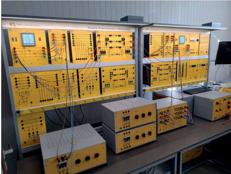
Rys. II.5.2. Model toru jednostronnie zasilanego
