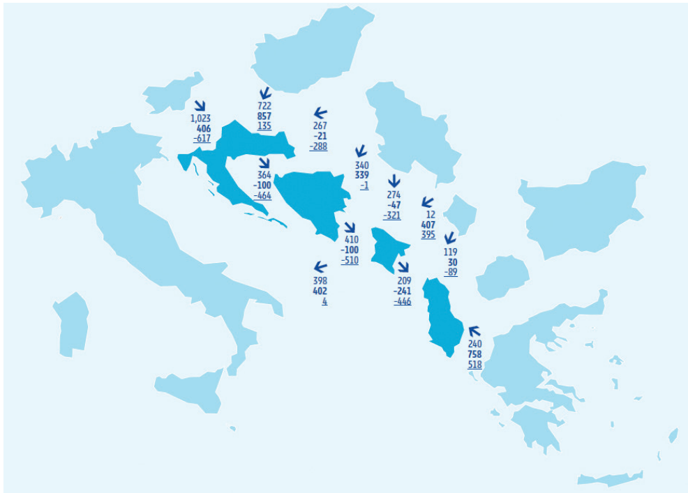
Rys. II.3.3. Handlowe wartości wymiany międzynarodowej w porównaniu z przepływami fizycznymi dla godziny 12:00, 21 czerwca 2024 r. [1]
