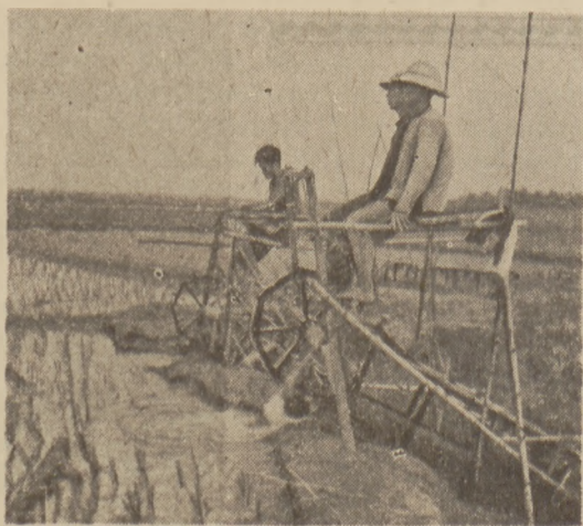
Prymitywny, ale na razie niezawodny sposób nawadniania pól ryżowych przy pomocy urządzeń poruszanych ...nogami.
