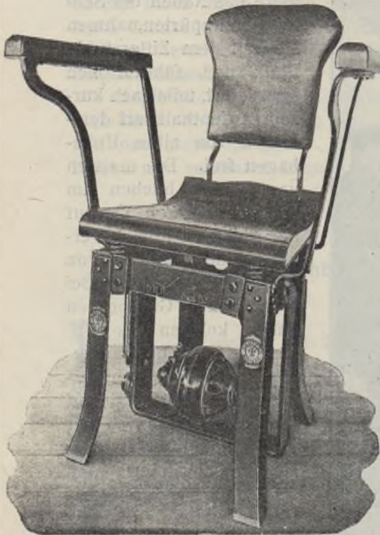
Der neue Vibrationsstuhl der Elektricitätsgesellschaft „Sanitas“-Berlin zur Verhinderung der Seekrankheit.
